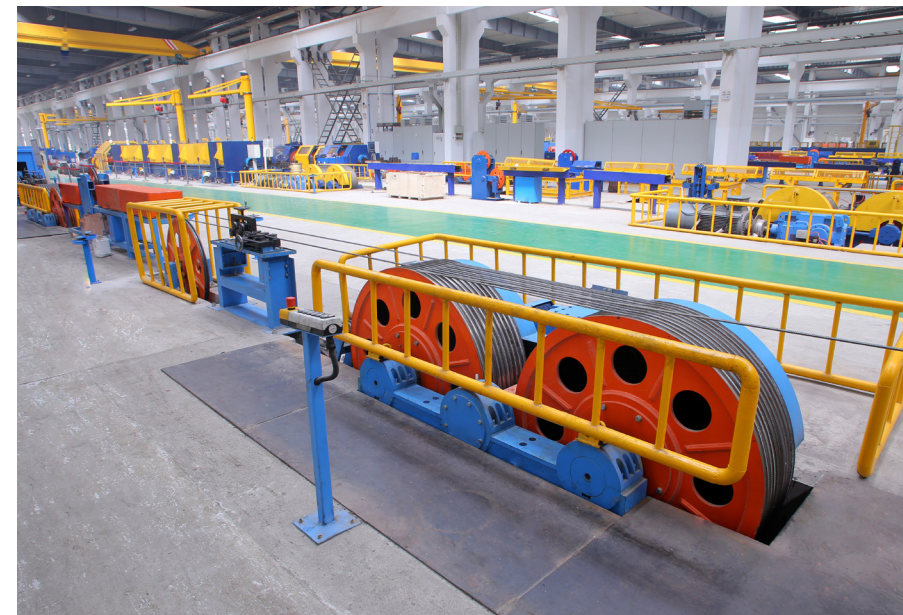
在线预张拉 On-line pretension
